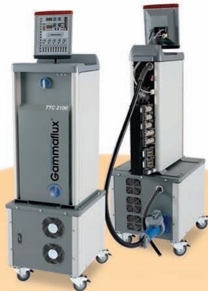
TTC 2100-2 (links), TTC 2100-1 (rechts), beide abgebildet mit einem optionalen 480 bis 240 Delta/Delta-3-Phase 2:1, 45 kva-Abspanntransformator. Integrierte Transformatorsockel bis zu 112 kva lieferbar.
